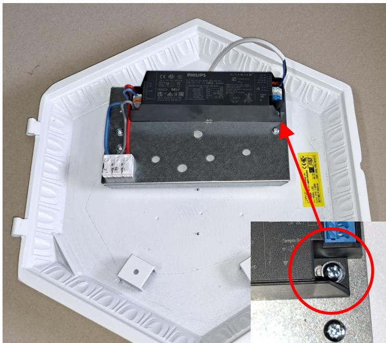
1. Przed przystąpieniem do demontażu modułu należy odłączyć oprawę oświetleniową od zasilania sieciowego. Kolejnym krokiem jest odłączenie przewodów z zasilacza, poprzez wypięcie ich z listwy zaciskowej. Następnie za pomocą śrubokręta krzyżowego, wykręcamy dwa wkręty mocujące zasilacz.
